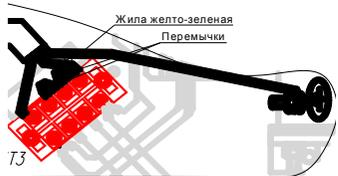
Рис.5 Схема подключения к однофазной сети. ЭВГМ-4,8...9.
