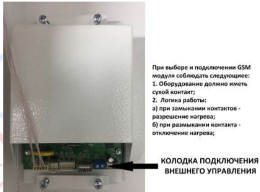
Рисунок 7. Подключение GSM модуля к электродкотлу РЭКО серии ПМ
