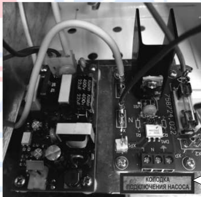
Рисунок 5. Подключение циркуляционного насоса к отопителю
