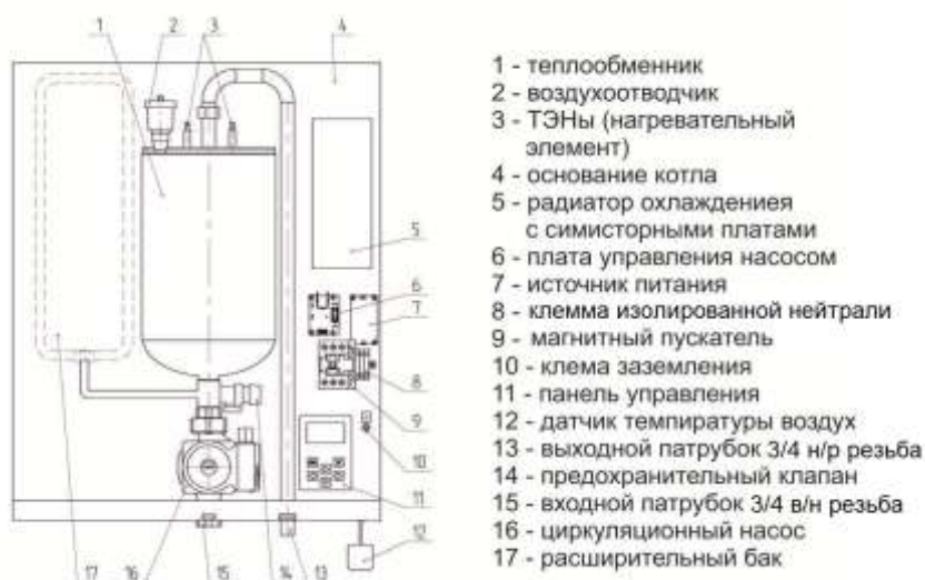
Рисунок 2. Устройство отопителя РЭКО серии ПМ
